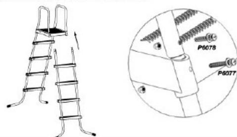
Abbildung 6 6. Ziehen Sie alle Schrauben fest. Installieren Sie P6213 (Warnstift). (Abbildung 6):
