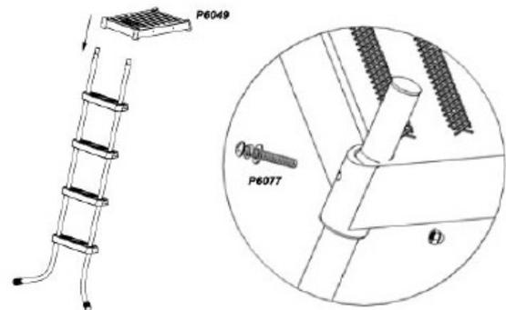
Abbildung 4 4. Montage der gebogenen Handgriffe (Abbildung 4):
