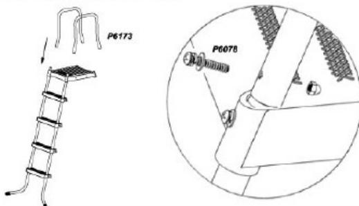
Abbildung 5 5. Montage der übrigen Stufen (Abbildung 5):
